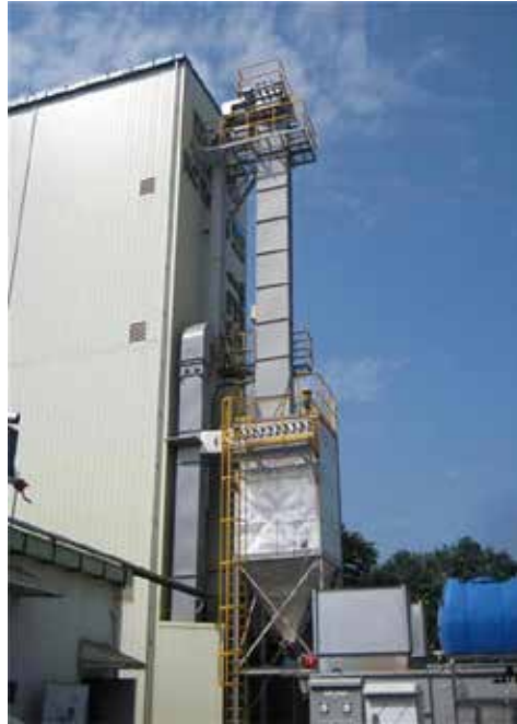
〈그림 7〉 6,000Nm 3 /hr 규모 15미터 백 필터 실험설비 사진
