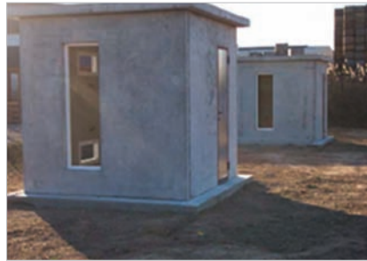
[ 그림 7 ] 콘크리트 블록 시험체
