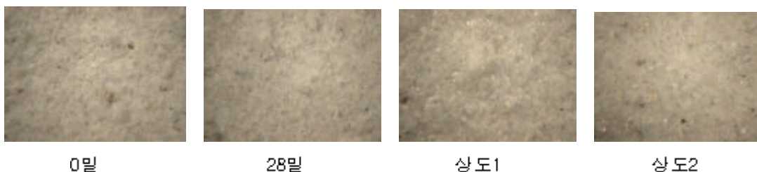
그림 9. 재령 및 상도에 따른 내약품성 현미경 사진( \times 500 )
